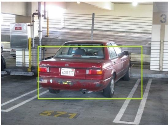
Das gesamte Nummernschild befindet sich innerhalb des interessierenden Bereichs, und das Nummernschild wird erkannt.
